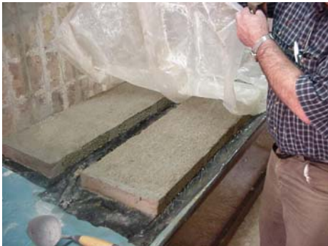
Fig. 5: Placas de ladrillos fabricados con films plásticos para embalaje de alimentos.
