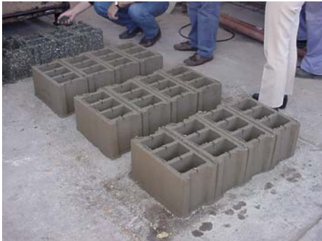
Fig. 4: Boques fabricados con PET.
