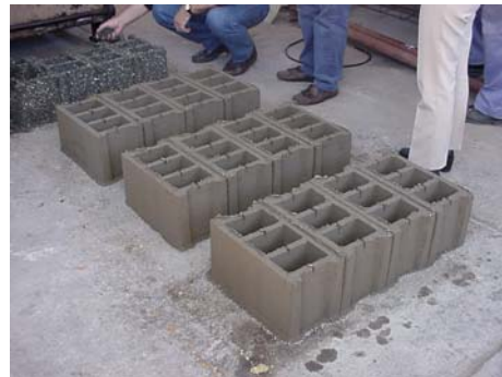
Fig. 2: Boques fabricados con PET.
